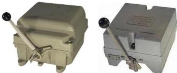
Контроллеры серии ККТ-60 предназначены для пуска, реверсирования и регулирования скорости вращения электродвигателей переменного тока серии МТ путем изменения схемы и величины включенных в электрическую цепь сопротивлений. По условиям эксплуатации и назначению контроллеры относятся к категориям АС-2, АС-3, АС-4 по ГОСТ 12434. Каждый контроллер имеет 12 электрических цепей.
